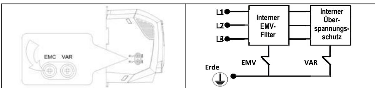
Die "VersiDrive i E2"-Produktpalette ist mit Überspannungs-Schutzkomponenten für die Eingangsversorgungsspannung ausgestattet, um den Umrichter gegen Störimpulse der Netzspannung zu schützen, die typischerweise von Blitzschlägen oder Schaltvorgängen von Hochleistungsgeräten an derselben Versorgung ausgehen.
